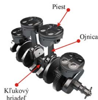
Obr. 3: Príklad konštrukcie kľukového hriadeľa s nasadenými ojnicami a piestami od firmy Yamaha.
