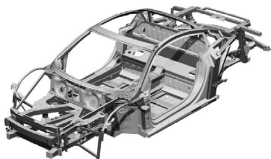
Obr. 3: Celohliníková karoséria Audi R8 z roku 2011 [39].
